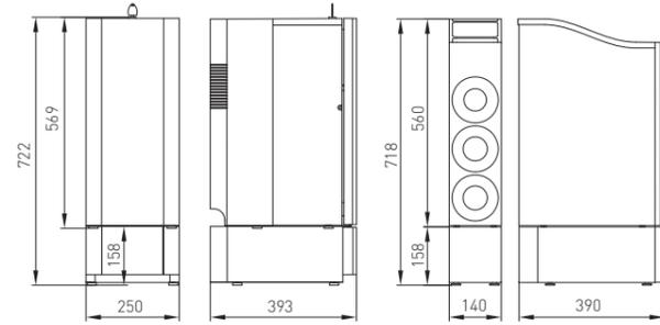
Beistellkühleinheit mit Unterstelleinheit
